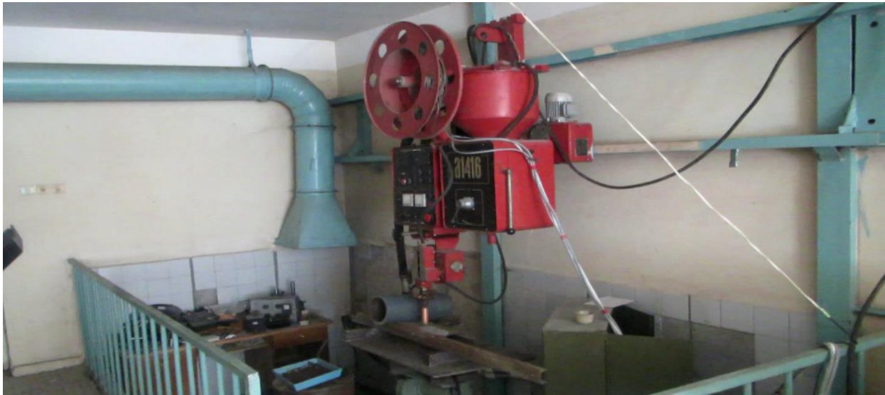
სურ. 3.1 ექსპერიმენტული დანადგარი გუთნების სახნისების მდნობის ქვეშ ავტომატური დადუღებისათვის.
